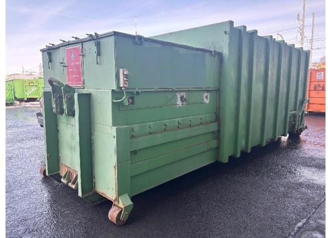
Abmessungen Aussen: L 7200 mm; B 2500 mm; H 2650 mm
