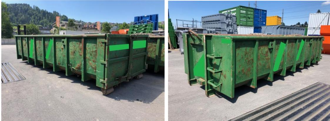
Abmessungen innen: L 6000 mm; B 2300 mm; H 1250 mm
