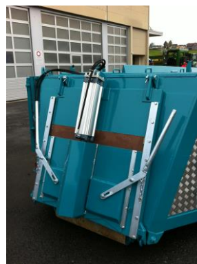
Pneum. Entleerungsklappe mit 2 Handauslaufschiebern
